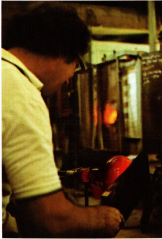
Le verrier souffle, façonne et aplatit le fond de la pièce.
