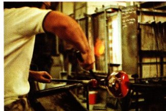
Le verrier souffle, façonne et aplatit le fond de la pièce.
